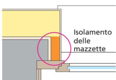
Quando si sostituiscono le finestre, bisogna proteggere le mazzette con almeno 2 cm (meglio di più) di isolante.
